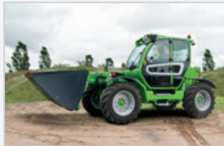
BSS De hydropneumatische BSS vering van de giek (optioneel) kan door de bediener geactiveerd worden, maar deactiveert automatisch onder 3 km/h.
